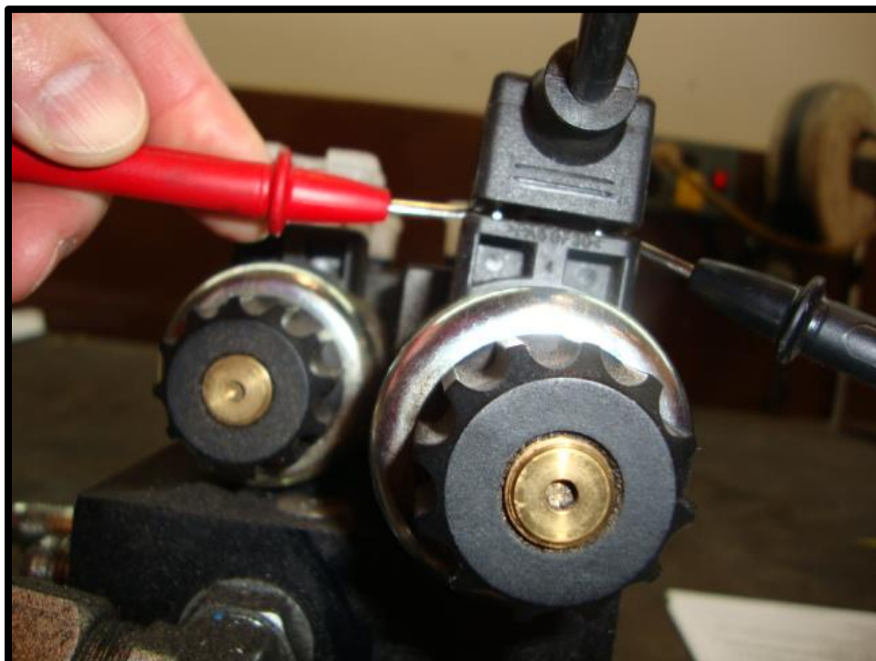
Figure 8.4 Checking Din Plug Voltage
